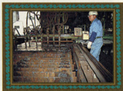
鋼板のガス溶断
